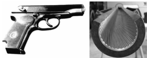
枪膛上的螺旋形槽
